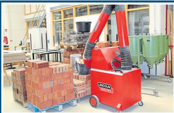
Wie viel Wasser kann ein Ziegelmauerwerk aufnehmen? Ziegelsteine für ein Mauerwerk zur Untersuchung der Schlagregendichtigkeit
