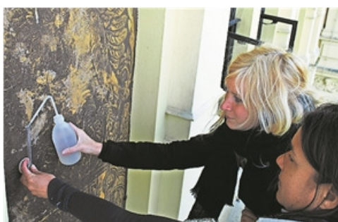
Krümelerde Kunst: Die Expertinnen für Wandmalerei bei der Wasseraufnahme-Messung (Festigkeit).
