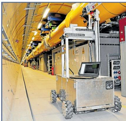
Der Inspektionsroboter für Beschleunigeranlagen ist in Zusammenarbeit mit dem Deutschen Elektronen-Synchrotron (DESY) in Hamburg entwickelt worden.
