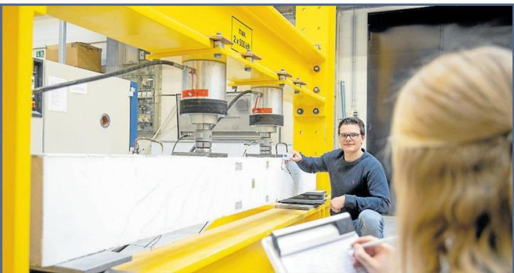
In dem gelben Lastrahmen, der bis zu 1 MN (Meganeutron) Kraft entfalten kann, belasten und prüfen Studierende ganze Bauteile. Hier zum Beispiel einen Stahlbetonträger.
