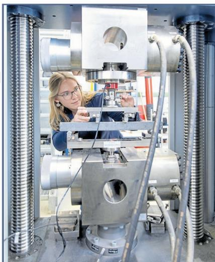
Die hs 21 versteht sich als Präsenzhochschule: In modern ausgestatteten Laboren wird praxisbezogene Forschung betrieben. Mit dieser Maschine lassen sich verschiedene Materialien in einem Zug-, Druck- oder Biegeversuch prüfen. Hier wird eine Estrichprobe einem Biegeversuch unterzogen.
