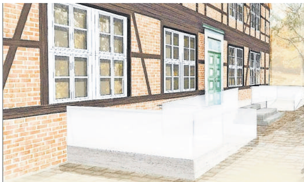
Eine Rampe aus Glas, damit die Optik der Amtshausfront nicht zerstört wird: So sieht der siegreiche Entwurf von Clara Droop für den Umbau des Eingangs aus. Entwurf Droop
