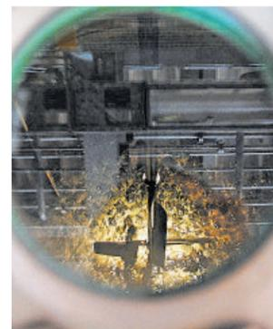
Durch das Bullauge: Blick in den Reaktorkessel, in dem gerührt wird.
