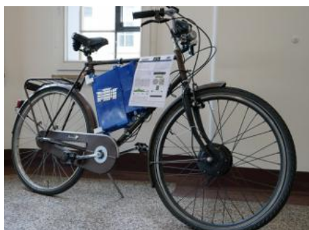
Dank des Umbausatzes wird aus einem herkömmlichen Fahrrad ein E-Bike.
