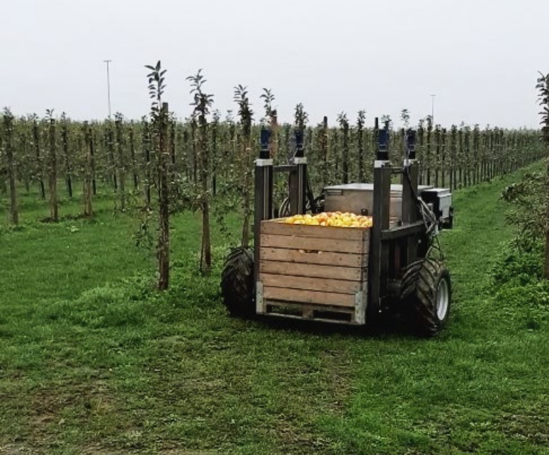
Abbildung 2: AurOrA Fahrzeug mit gefüllter Obstkiste (ca. 350 Kg)
