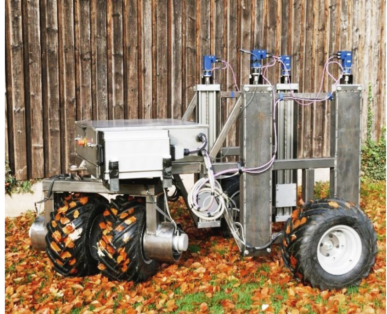
Abbildung 3: Lenkung der Fahrzeugs durch die Vorderräder
