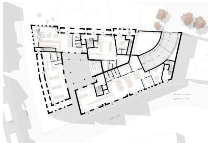
Auflösung des Blockrands in Einzelhäuser; zur Bildung einer Kantenrigel und feinen Körnung
