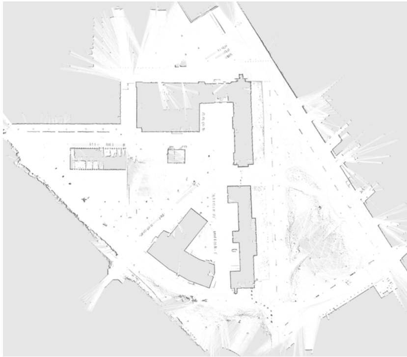
Abbildung 8: Beispielkarte erzeugt mit Gmapping
