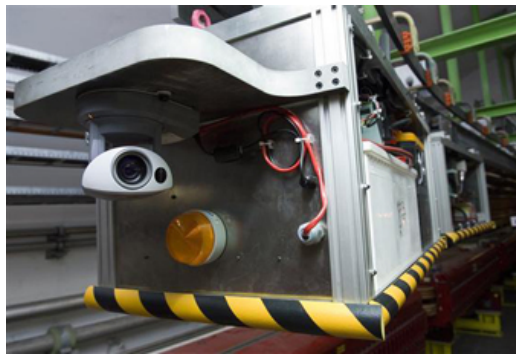
Abbildung 2: Schienenbasiertes Robotersystem TIM im Large Hadron Collider (LHC)
