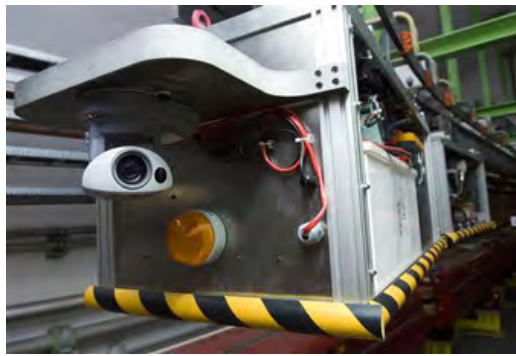
Abbildung 2: Schienenbasiertes Robotersystem TIM im Large Hadron Collider (LHC)
