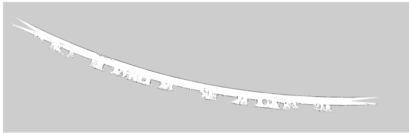
Abbildung 11: Nicht korrekt eingestellte Laserdaten führen zu Krümmung des geraden Tunnels
