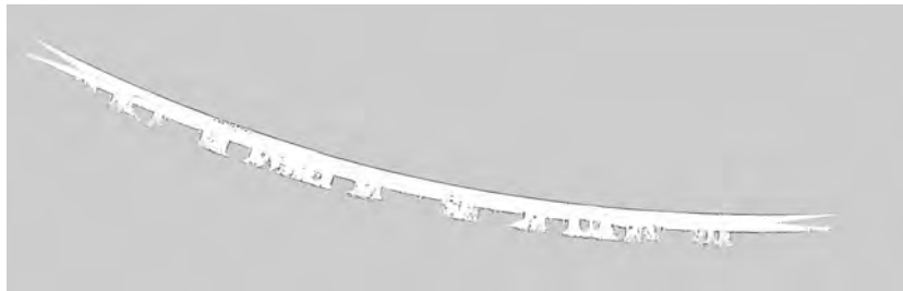
Abbildung 11: Nicht korrekt eingestellte Laserdaten führen zu Krümmung des geraden Tunnels
