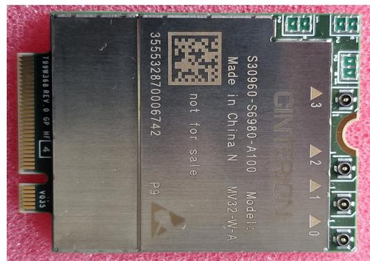
Abbildung 10: M.2 Funkmodul Cinterion MV32 von Thales / Ericsson (Rel. 16)
